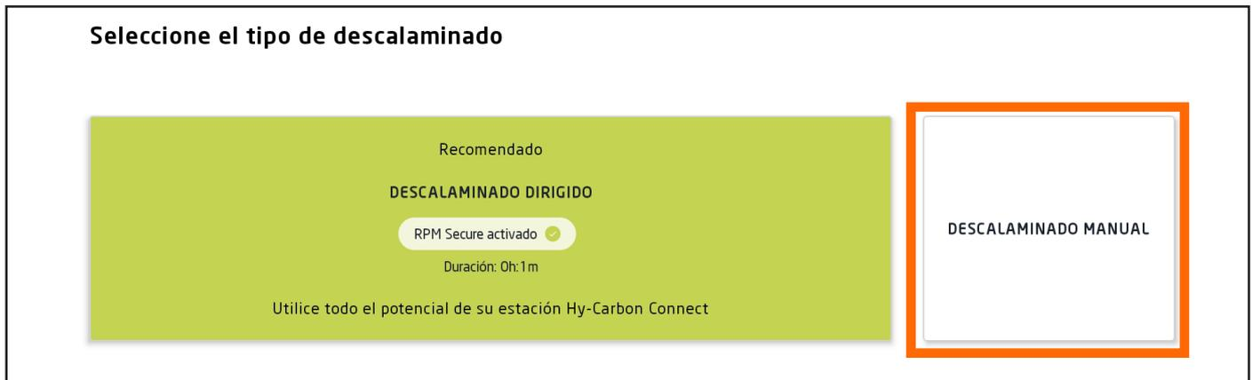
Tras la etapa del primer diagnóstico (22), es posible elegir una descarbonización dirigida, recomendada, ya que la estación optimiza el proceso para una eficacia óptima. La descarbonización manual permite elegir manualmente la duración del tratamiento que se va a efectuar.
